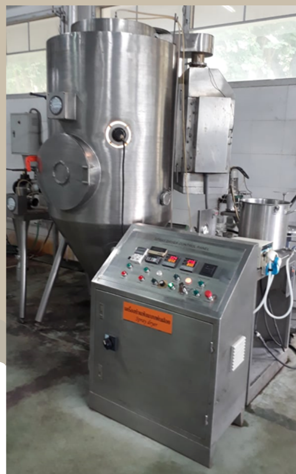
เครื่อง Spray Dryer กำลังการผลิต 3-5 L/hr
